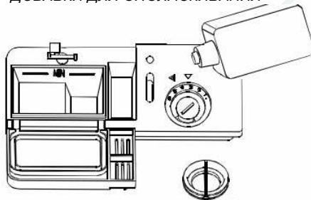
Добавка для ополаскивания вводится в посудомоечную машину на конечной стадии ополаскивания посуды для того, чтобы на посуде не образовывались капли, из-за которых на ней возникают пятна и разводы. Добавка для ополаскивания также способствует ускорению сушки посуды, так как обеспечивает стекание с нее воды без образования капель.
